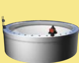
Плоскостность кольцевых плоскостей (например, фланцев).
