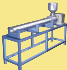
Прямолинейность и угловое положение труб экструдеров.
