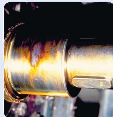
Антифреттинговая паста SKF LGAF 3E предотвращает появление фреттинг-коррозии, которая возникает при малых перемещениях или вибрации и значительно осложняет процедуры демонтажа.
