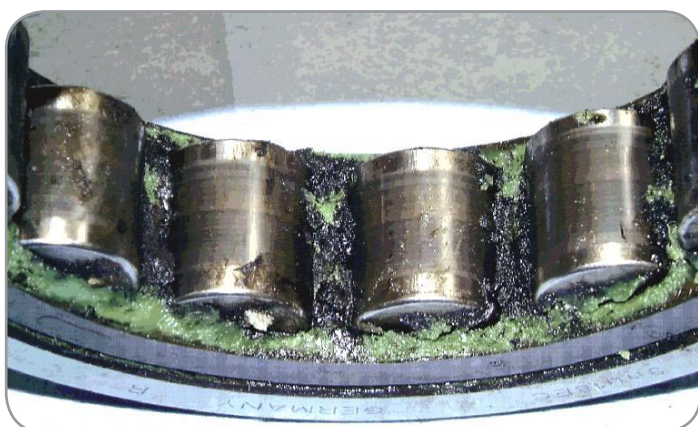
Деградация смазки по причине токов электрического разряда
