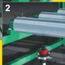
1 Измерение уровня роликов. (Детектор со скользящим креплением на валу).
