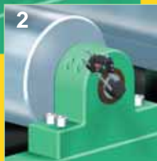
1 Измерение уровня роликов. (Детектор со скользящим креплением на валу).
