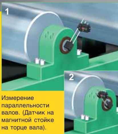
1 Измерение уровня роликов. (Детектор со скользящим креплением на валу).
