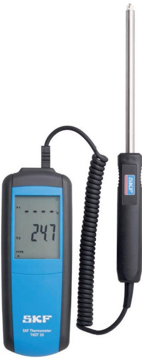
Точное двухканальное измерение температуры.
