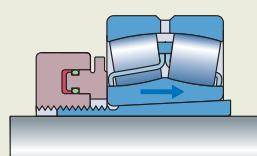
2. Смажьте сопряжённые поверхности деталей тонким слоем масла (например, SKF LHMF 300) и осторожно установите подшипник на вал.
