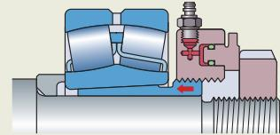
Гидравлическая гайка серии HMV ..E и специальная упорная гайка для монтажа на стяжную втулку.
