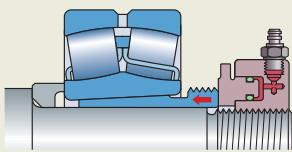
Гидравлическая гайка серии HMV ..E используется для монтажа подшипника на стяжную втулку.
