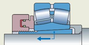
4. Подайте масло в гидравлическую гайку и переместите подшипник в начальное положение. Давление контролируется с помощью цифрового манометра, установленного на соответствующем насосе.
