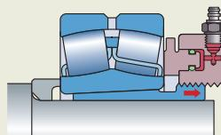
Демонтаж подшипника на стяжной втулке с помощью гидравлической гайки серии HMV ..E.
