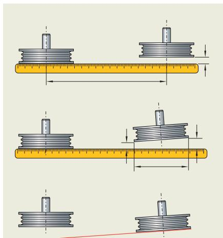
Измерение параллельного и углового перекоса с использованием поверочной линейки или натянутой струны
