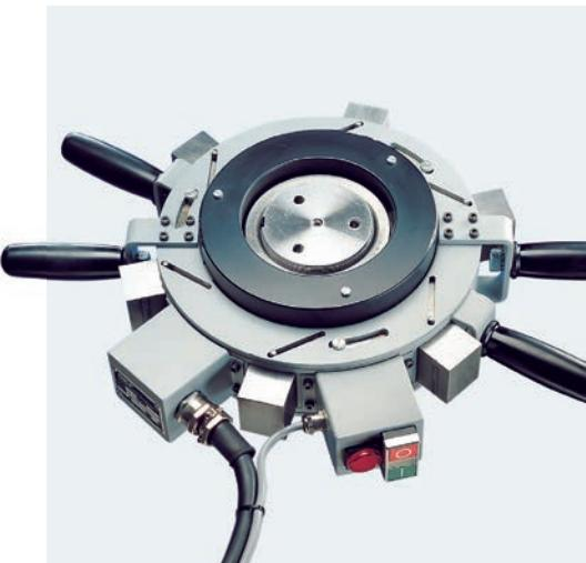
Для частого демонтажа цилиндрических роликоподшипников
