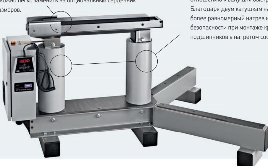
Двойная катушка обеспечивает высокоеэффективный нагрев подшипников в горизонтальном или вертикальном положении. Такая гибкость позволяет нагревать подшипник в нужной ориентации по отношению к валу для быстрого и удобного монтажа. Благодаря двум катушкам нагреватели обеспечивают более равномерный нагрев и повышенную степень безопасности при монтаже крупногабаритных подшипников в нагретом состоянии.
