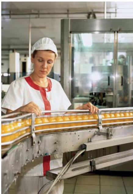
Сухая смазка SKF LDTs 1 специально разработана для автоматических систем смазывания пластиковых поверхностей ленточных конвейеров, использующихся при производстве напитков. Эта смазка состоит из синтетического масла с твёрдой смазочной добавкой из PTFE.
