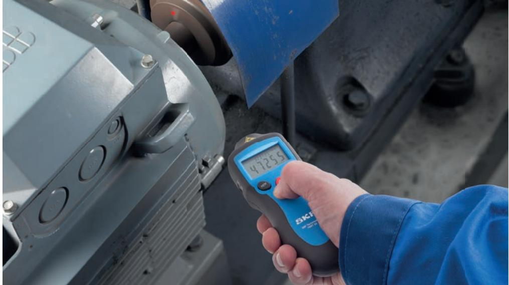
Оптическая лазерная система обеспечивает простое и быстрое измерение на безопасном расстоянии от узлов вращения.
