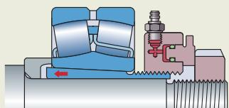
Демонтаж подшипника на закрепительной втулке с помощью гидравлической гайки серии HMV ..E и упорного кольца.
