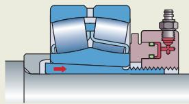
Гидравлическая гайка серии HMV ..E используется для монтажа подшипника на закрепительную втулку.
