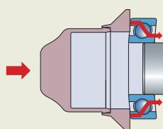
Неравномерное распределение усилия приводит к повреждению подшипника
