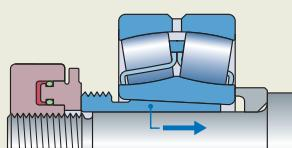
5. Переместите подшипник вдоль конической поверхности на расстояние, указанное в программе, приложении или на сайте [skf.com/mount](http://skf.com/mount). Смещение измеряется специальным индикатором часового типа. Гидравлические гайки SKF HMV..E имеют специальные отверстия для установки индикатора. Данный способ монтажа подшипника обеспечивает необходимый натяг и заданный остаточный зазор.
