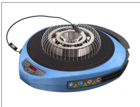
Abb. 1 – Magnetfeld um das Lager
