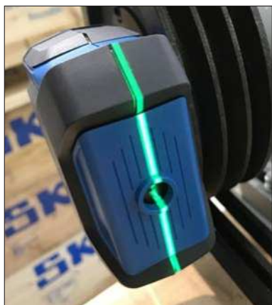
图 6 - 水平角度不对中的显示情况
