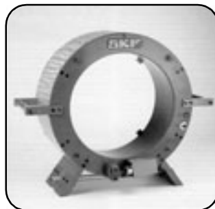
Εικ. 3. Ειδική εκτέλεση για ακανόνιστα και μεγάλου μεγέθους εξαρτήματα εξωτερική διάμετρος
