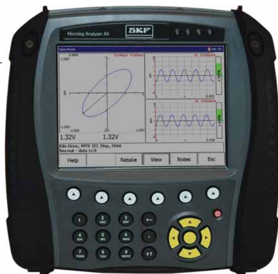
SKF Microlog Analyzer AX – самый передовой, 4-канальный, маршрутный и внемаршрутный сборщик данных/анализатор спектров.
