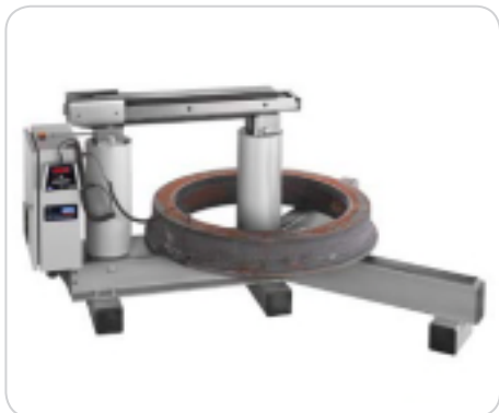
Рисунок 5: TIH L с горизонтальным нагревом детали
